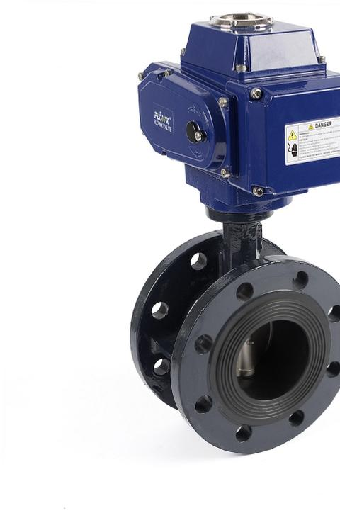
**B. 电动开关蝶阀**的主要优点：结构简单，体积小重量轻，造价低，安装在高空暗道，也可调节流量介质。流体阻力较小，中大口径的**电动开关蝶阀**全开时有效流通面积较大，启闭迅速省力，碟板旋转 90 角度即可完成启闭，由于转轴两侧碟板手介质作用力接近相等，而产生的转矩方向相反，因而启闭力矩较小，低压下可实现良好的密封，**电动开关蝶阀**密封材料有丁晴橡胶、氟橡胶，食用橡胶，衬四氟故密封性能良好，无论在任何情况下均具有优良的密封性能(最高可达零泄露)。**电动开关蝶阀**可广泛应用于食品，环保，轻工，石油，化工，教学设备，造纸，电力等到行业的工业过程自动控制系统中。
