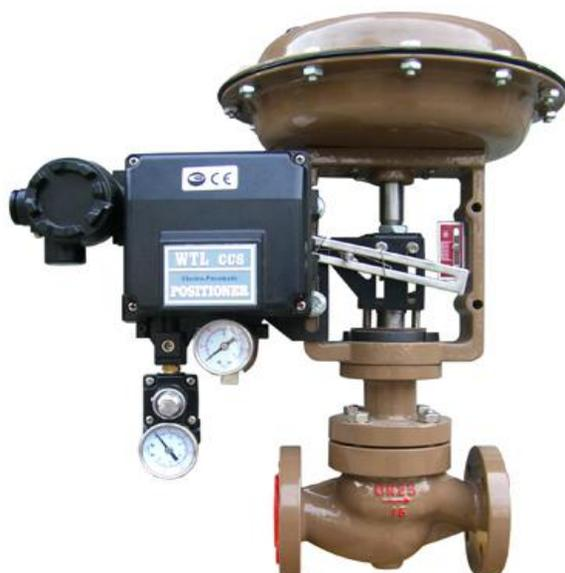
B. ZJHM 系列**气动薄膜套筒调节阀**因为其稳定性好、维护简单而广泛应用，可设计成平衡式消除了阀瓣上的大部分静态不平衡力，并有一定的阻尼作用，可以减小流体流动引发振动，能用于压差相对较大的场合，可选择多弹簧气动薄膜机构或电动执行机构等。
