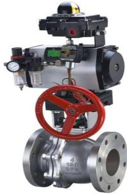
本公司生产的**气动 O 型切断球阀**是由双(单)作用气动活塞式执行器和浮动球阀组成。亦配行程限位开关、电磁阀、减压阀及 0.4-0.7MPa 气源可实现开关操作，并送出二对无源触点信号指示阀门的开关。**气动 O 型切断球阀**是以压缩空气为动力，阀杆带动阀芯在阀体内转动 90°，以实现全开——全闭的动作，**气动 O 型切断球阀**按其密封性能可分软密封阀座及金属密封阀座。软密封阀座适用于温度 $\leq 260^{\circ}$  的场合，金属硬密封阀座适用于温度 $\leq 500^{\circ}$  的场合。**气动 O 型切断球阀**具有结构紧凑、体积小、行可靠、密封性好、维修容易等特点。气动 O 型切断球阀广泛的应用于石油、化工、轻工、制药、造纸等工业自动控制系统中。
