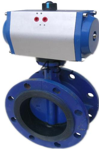
**气动开关蝶阀**亦属中线软密封蝶阀，是管线优先选用的常规蝶阀，具有结构简洁，流阻系数小，流量特性趋于直线，不会滞留杂物。且重量轻，安装方便，驱动扭矩较小的优点。**气动开关蝶阀**既可作切断介质用，又可作调节介质的流量用。阀体密封圈分丁晴橡胶、四氟橡胶，泄露量可达零。选用不同材料的零件，配用不同材料的密封圈，可适应不同的介质、工况，使成本与性能达到最佳效果。**气动开关蝶阀**适用于温度 $\leq 120^{\circ}\text{C}$ 或 $\leq 150^{\circ}\text{C}$ ，公称压力 $\leq 1.6\text{MPa}$ 给排水、污水、食品、供暖、燃气、船舶、水电、冶金、能源系统以及轻纺等行业，特别适用于泄露量要求较高、有腐蚀性的场合，作调节流量和截流介质。
