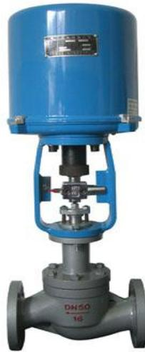
ZRSM 电动套筒调节阀因其稳定性好、维护简单而广泛应用，可设计成平衡式消除了阀瓣上的大部分静态不平衡力，并有一定的阻尼作用，可以减小流体流动引发振动，能用于压差相对较大的场合。
