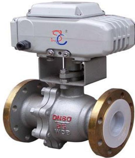
**B. 电动开关球阀**是指启闭件（即球体）由阀杆带动，并绕阀杆的轴线作旋转运动的阀门。主要用于截断或接通管路中的介质，亦可用于流体的调节与控制。是一种转角为 90°的旋转类球阀，采用角行程电动执行器(DSR、PSQ、HQ、DZW)及球阀阀体组成。**电动球阀**适用于两位切断、调节的场合，采用一体化结构，电动执行机构内置伺服系统，无须另配伺服放大器，输入 4-20mA 控制信号或 1-5VDC 及 220VAC 电源即可控制运转。**电动开关球阀**具有连线简单，结构紧凑、尺寸小、重量轻、阻力小、动作稳定可靠等优点。特别适用于介质是粘稠、含颗粒、纤维性质的场合，目前该电动开关球阀广泛用于石油、化工、冶金、轻工、造纸、电站、制冷等工作领域。
